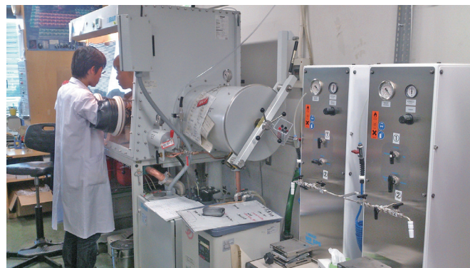
図1 グローブボックスとドライソルベントシステムを利用した Air-free 技術。ほぼすべての重合行程をグローブボックス内(酸素と水はともに 1 ppm 以下 S1 )で行うことで再現性の良い精密重合が可能となる。ニードルバルブ付きフラスコにより乾燥試薬をグローブボックス内に入れる S1 。
